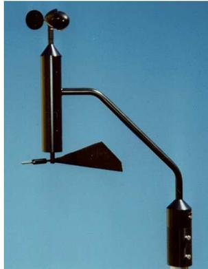
Schalensternanemometer und Windfahne werden kontinuierlich an allen Stationen durch USA ersetzt
