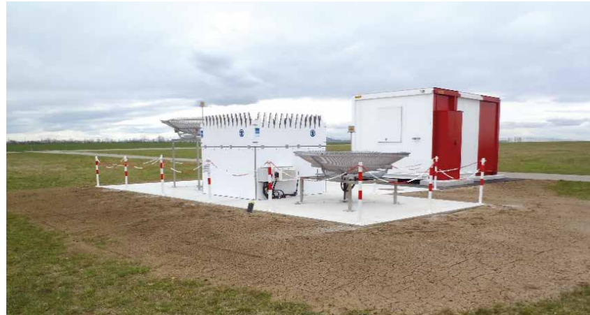
SODAR-RASS-Anlage für Analysen bis ca. 500 Meter über Grund SODAR-RASS equipment for analysing up to 500 metres above ground
