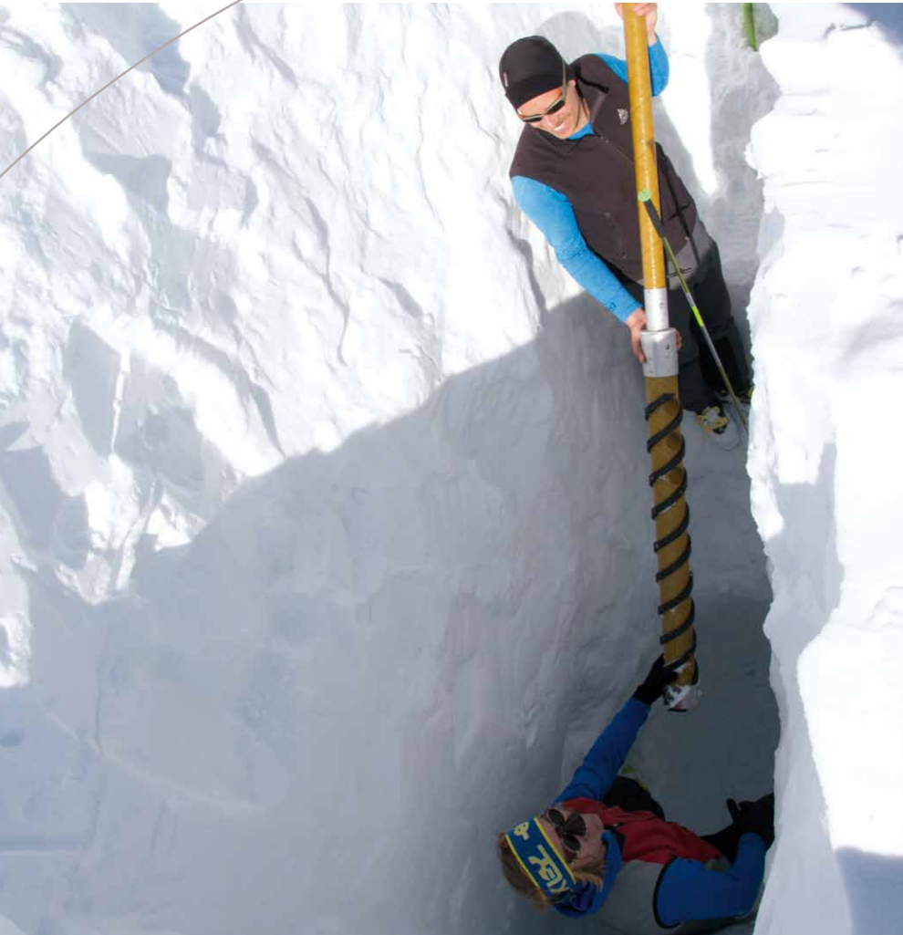
Aufwändige Messung der Schneedichte zur Bestimmung der Massenbilanz Sophisticated measurement of the snow thickness to determine the mass balance
