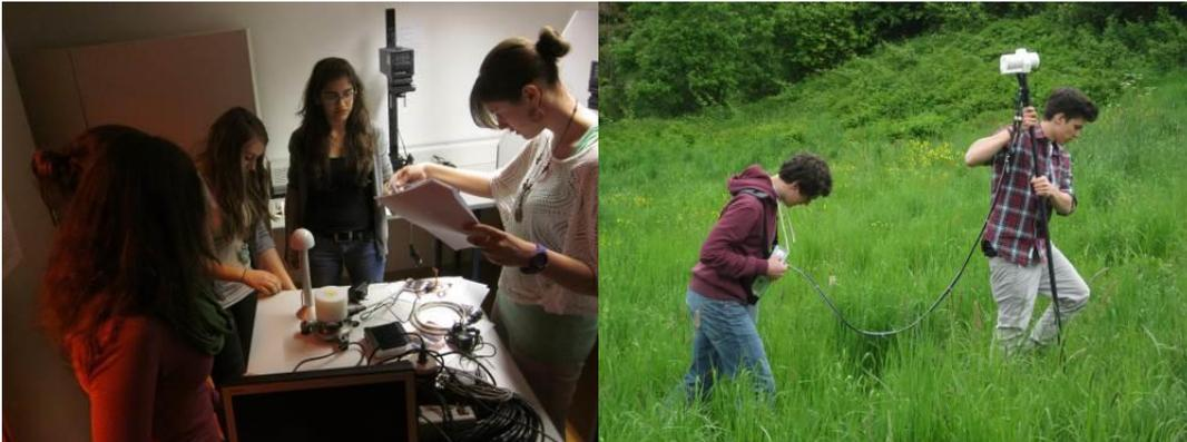
**Abb. links: Erster Aufbau:** Schülerinnen des BG Tamsweg bei ersten Tests mit dem Variometer-System. Damit werden die einzelnen Komponenten des Erdmagnetfeldes gemessen (entlang der x-, y- und z-Achse). Quelle: ZAMG/Leichter.
